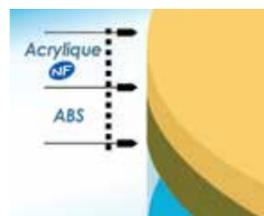
Matériau bimatériau constitué d'acrylique coulé grade sanitaire et d'un renfort à base d'ABS.
